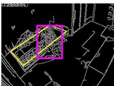
黄色い枠はベッドから出ようとしている状況。 赤い枠は、人物検知状況
